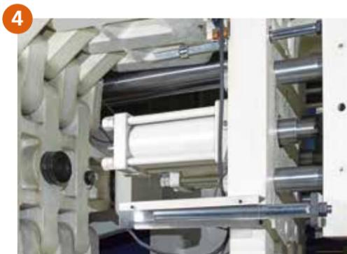
顶针位置控制采用 MTS 磁致尺 + 近接开关，双重配置，方便切换。
