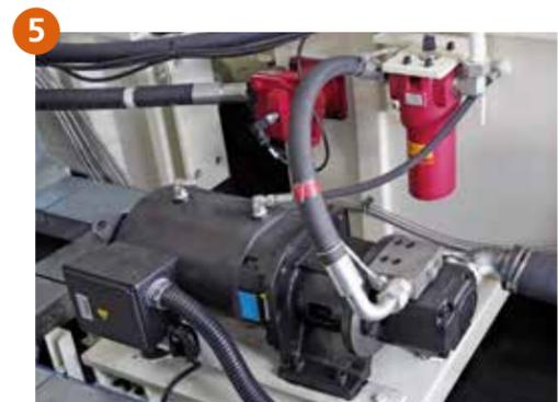
采用海天高性能伺服系统，节能显著，配置高效稳定的油冷方式，同时采用独立油箱，清洗保养方便，对液压系统更有保障。
