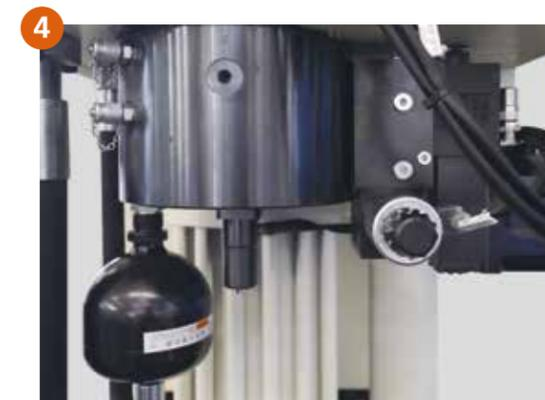
4 一快、二快、增压速度比例控制；二快、增压储能压力传感器自动检测。
