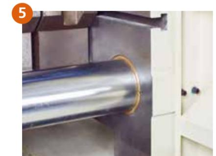
5 头板哥林柱孔加装铜套并增加润滑点，有效防止锈蚀，方便哥林柱的拆装。
