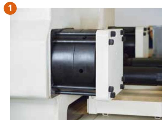
1 头板哥林柱螺母采用独特的超应力保护机构，在模具出现受力不均衡时可有效保护拉杆，显著延长使用寿命。
