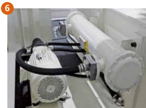
独立泵液液压油水冷系统，主动性冷却，冷却效果更好更可靠。
