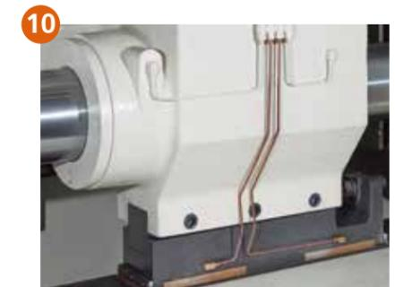
10 中板加长导向套结构，可确保中板运行更加顺畅，更加可靠。
