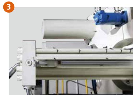
开锁模行程控制采用 KTS 磁栅尺，抗干扰能力强。
