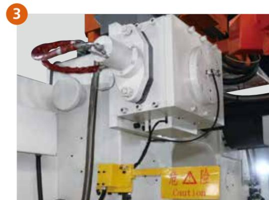
3 操作侧上方一根液压抽拉杆，并预留后侧上方液压抽拉杆安装位置，可供自由选配。
