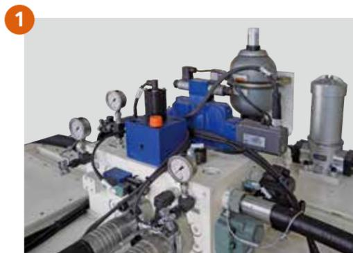
采用大流量电比例阀控制开锁模，开合模反应更快，位置更精准，同时配置锁模液压安全阀，锁模安全保护更可靠
