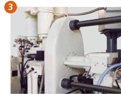
企板加厚、拉杆加粗，有利于机器长时间使用压射同心度的保持。
