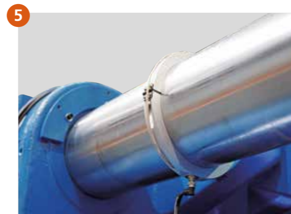
5 新增环式锁模力传感器，实时监控锁模力。
