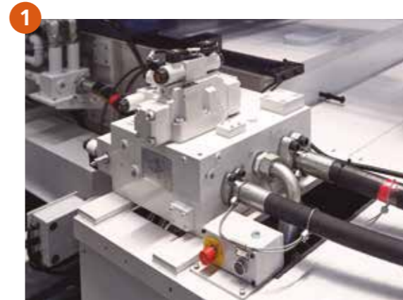
1 采用海天金属独有的大流量电液阀开合模系统，开合模反应更快，动作更平稳，锁模安全保护更可靠。
