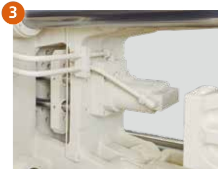
3 中板增加支撑筋板结构，有效降低中板的变形量，且将顶针油缸固定在筋板上，解决了顶针油缸摆动、顶出力不均匀、断顶针、顶出油缸活塞杆断裂等问题。
