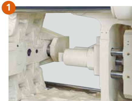
1 机铰采用 n \times n + 1 结构设计，且锁轴相应加粗加长，锁轴承载压应力小，有效延长机铰大修时间及使用寿命。
