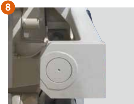
8 推力座导柱采用 42CrMo 材质并经氮化处理，推力座导柱的直径达到哥林柱直径的 80%，强度高，可确保机铰运动平稳。
