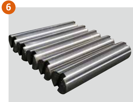
6 锁轴采用 38CrMoAl 材质并经氮化处理，超大直径，强度高，韧性好，使用寿命长。
