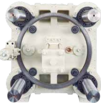
全新设计的调模机构，机铰可伸直调模，同时调模马达附有自锁功能，有效的解决因合模机构后退导致锁模力下降的问题，更好的保障产品的稳定性。
