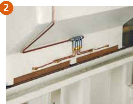
2 尾板采用无压板设计，开合模过程中，尾板不会进行窜动。
