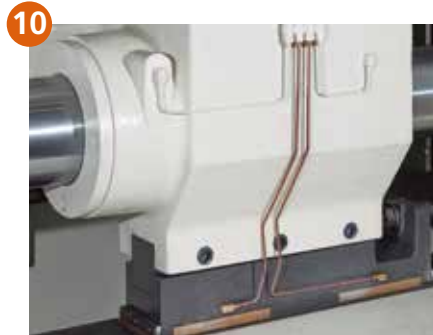
10 中板加长导向套结构，可确保中板运行更加顺畅，更加可靠。
