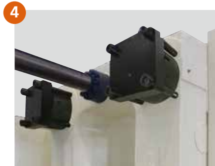
4 头板螺母压盖加厚、螺丝加粗，解决了高压开锁模瞬间因压盖、螺丝变形导致锁模力精度下降的问题。
