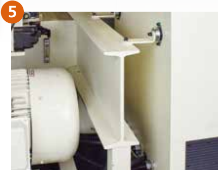
机身采用高强度工字钢结构，模板滑脚中心线、上下哥林柱中心线与工字钢支撑筋在同一平面，并经过退火工艺处理，机身抗扭曲能力和刚性大大加强，确保机器长时间使用的整体精度。
