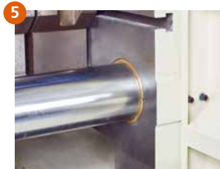
5 头板哥林柱孔加装铜套并增加润滑点，有效防止锈蚀，方便哥林柱的拆装。
